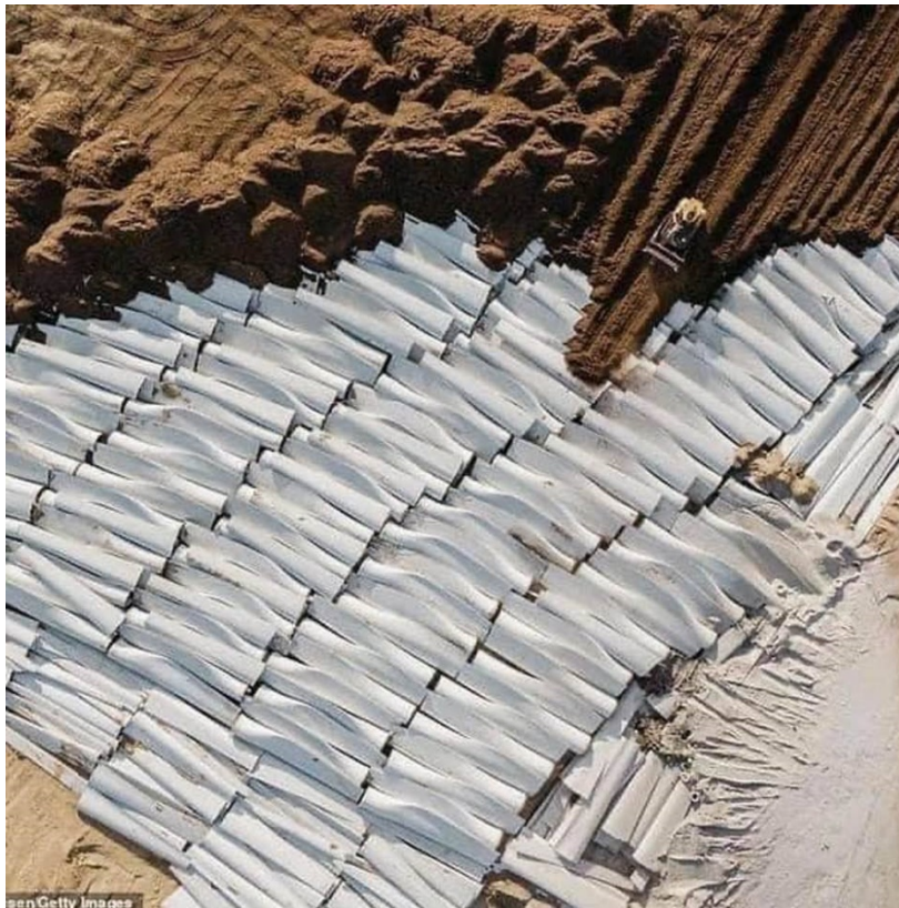
Figur 1 Deponi för skrotade rotorblad. Notera hur liten den jättelika grävmaskinen ser ut.
